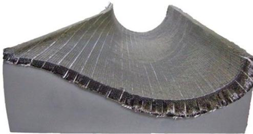
Bild 1: Der Vorteil des Mapretec-Verfahrens liegt in der Zeitersparnis bei der Drapierungszeit der Gelege und der Möglichkeit, die Preform-Prozesse parallel laufen zu lassen. (Foto: Saertex)
